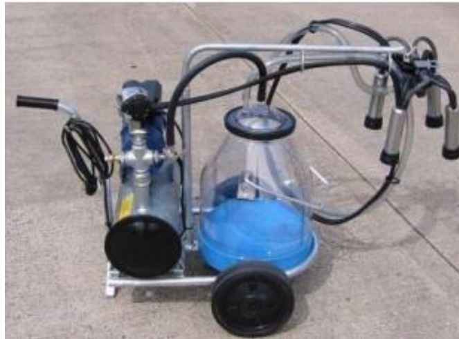
Figura 6: cubo móvil, conectado a un sistema de vacío (Ponce de león, 2010)
