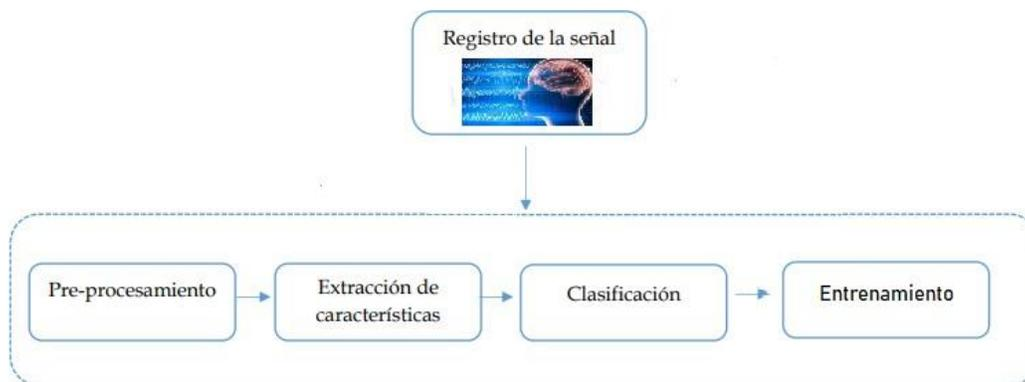
Fig 4. Esquema de procesamiento de la señal EEG. Fuente: propia
