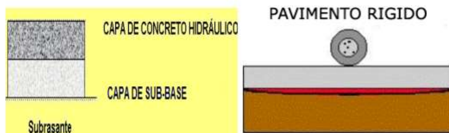
Figura 7. Estructura de un pavimento rígido
