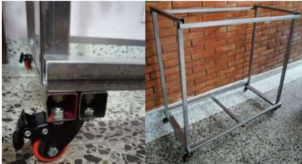
Figura 22 Estructura terminada con sistema de bloqueo
