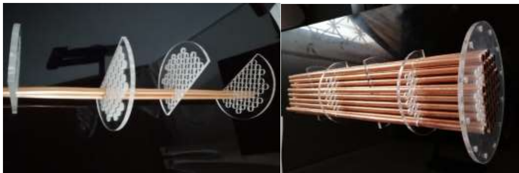
Figura 23. Instalación de tubería en los deflectores
