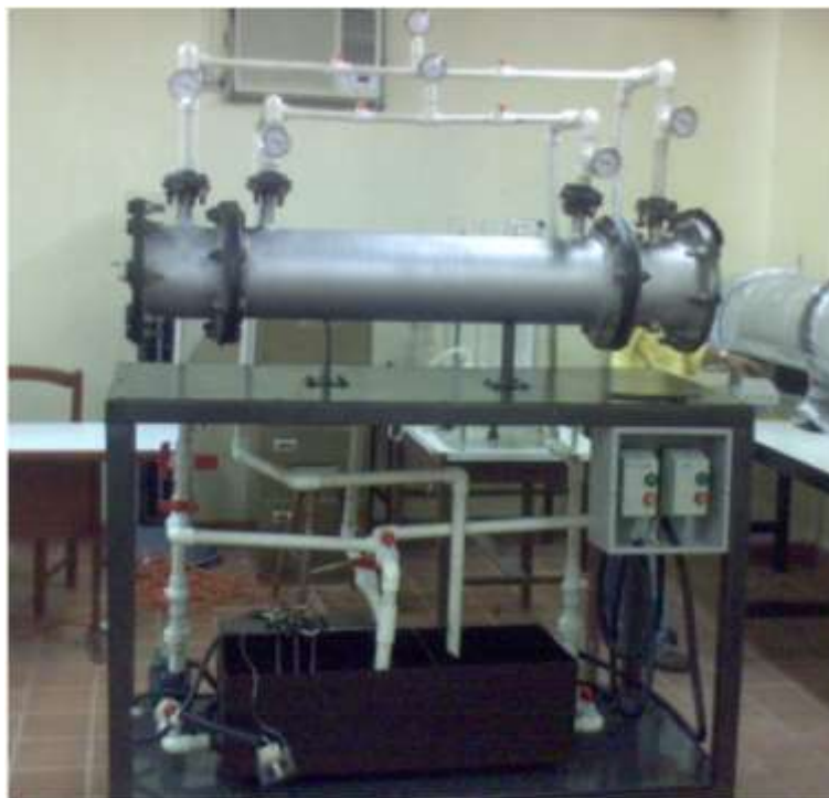
Figura 16. Intercambiador de calor de tubo y coraza
