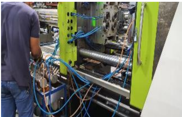
Imagen 3 Proceso de enfriamiento de los moldes en la entrada y salida
