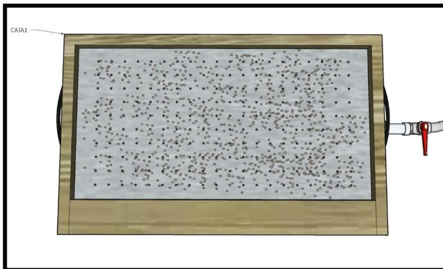
El proceso que realiza la maquina principalmente es de succión, consiste en depositar la semilla a utilizar dentro de la caja de madera.
