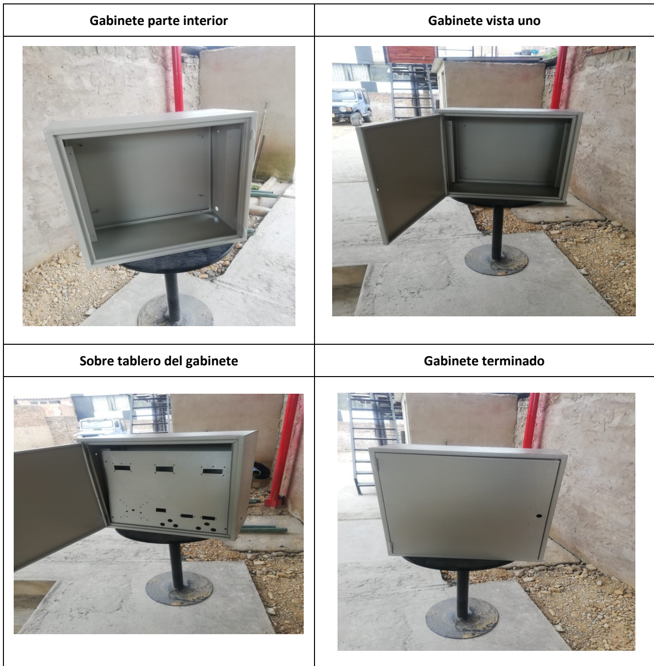
Figura 2-8: Mecanizado del sobre tablero.
