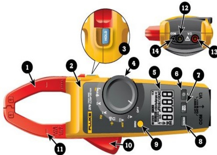
Figura 1-1: Características de una pinza amperimétrica.
