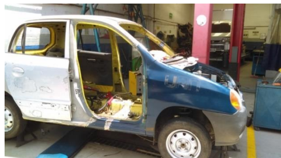
Fig. 16: Carrocería del banco de prueba ensamblada
