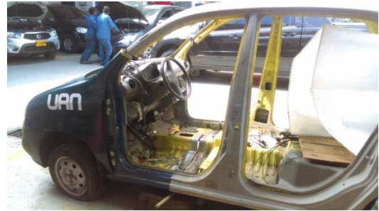
Fig. 15: Acople carrocería parte delantera y trasera
