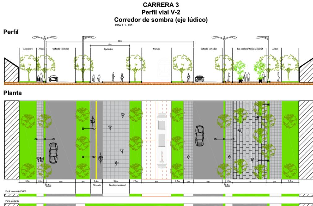
*Ilustración 58. Perfil vial carrera 3 V-2. Fuente: Elaboración propia.*
