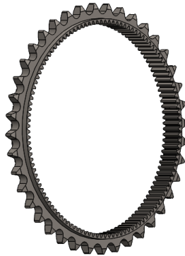
Figura 15: Diseño del engrane interno especial para zanjado.
