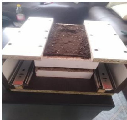
Figura 13: Modelo de ensayo de corte de suelo.
