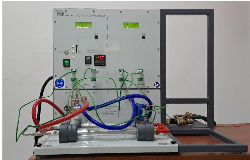
Figura 1 – Intercambiador de calor
