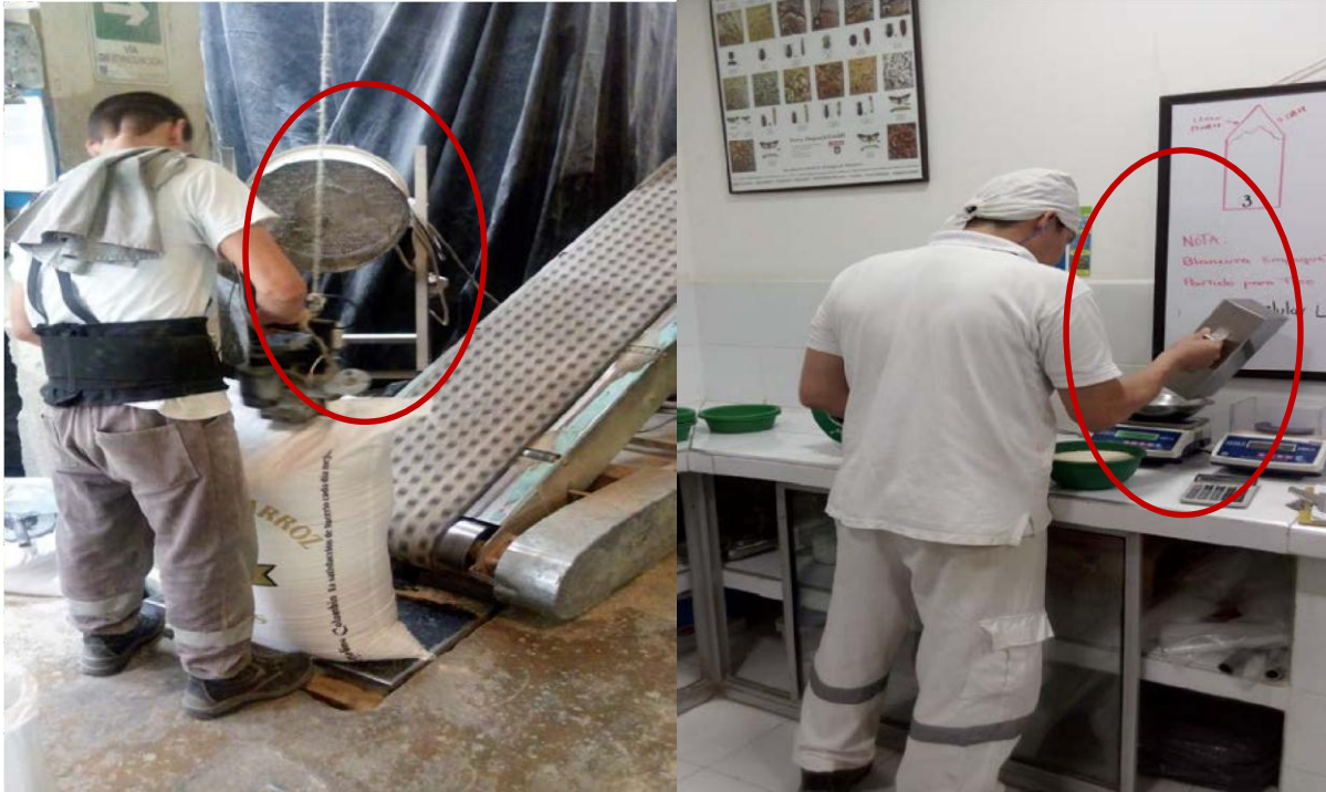
donde se evidencia la falta de protección ocular (gafas) exponiéndose a laceraciones y traumas 14-15. Área de almacenamiento, empaquetado, carga. del molino Colombia. Fuente propia, producidas por un cuerpo extraño.
