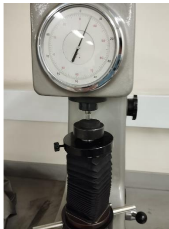
Figura 11: Registro fotográfico del ensayo de dureza – elaboración propia
