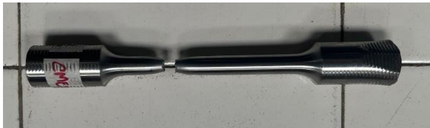
Figura 12: Ruptura del acero 4340 sometido a ensayo de tensión – elaboración propia
