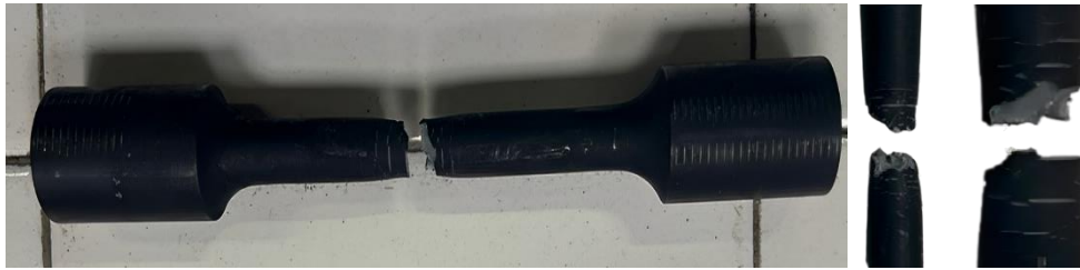
Figura 32: Ruptura probeta acero AISI 4340 nitrurado- elaboración propia
