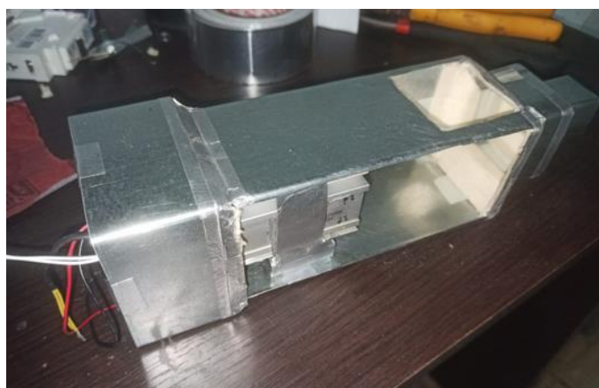
Ilustración 27. Ensamble unidad manejadora de enfriamiento y calefacción.
