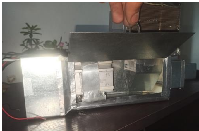
Ilustración 28. Montaje intercambiadores y motores-ventiladores.
