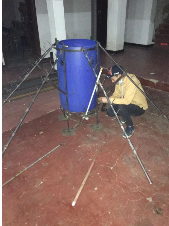
Figura 29. Instalación brazos para colectores (Autores)
