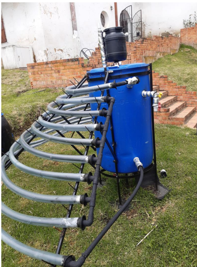
Figura 32. Calefactor solar (Autores)
