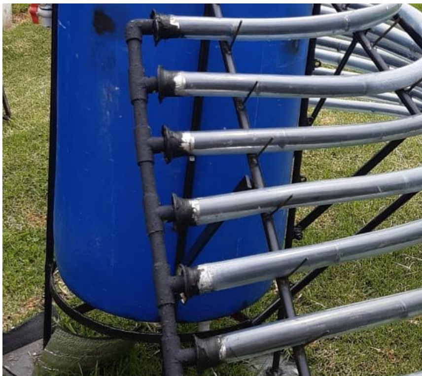
Figura 30. Conexiones entre colectores pintadas de Negro (Autores)
