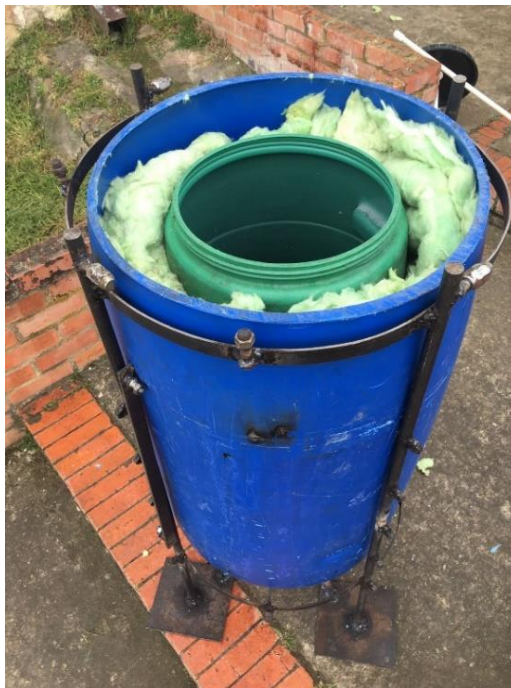
Figura 28. Relleno aislante tanque de almacenamiento (Autores)
