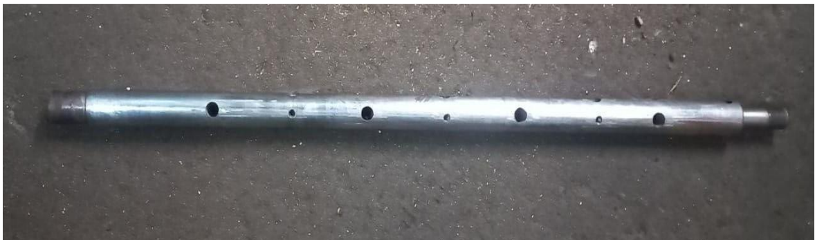
Figura 4-4. Eje portaherramientas mecanizado
