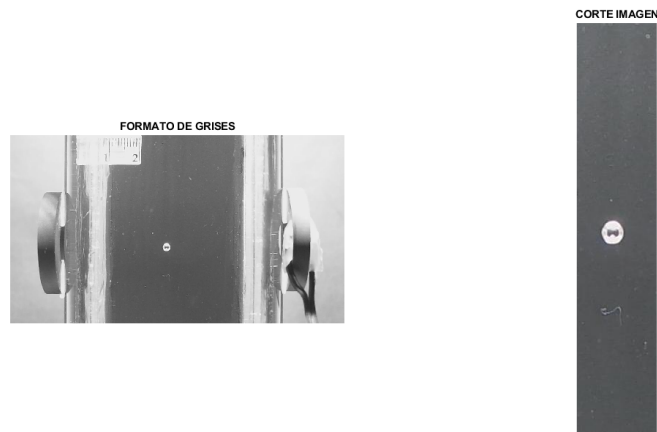
Figura 4-3.: Procesamiento de imágenes. Recorte de la imagen. En la imagen de la izquierda, se muestra la fotografía en tonos de gris. En la derecha se muestra el recorte de la zona de interés donde el único objeto relevante es la burbuja. Autor.
