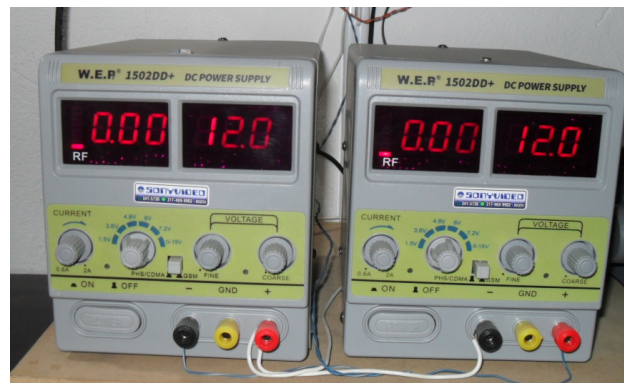
Figura 3-12.: Fuentes Reguladas de Voltaje. Autor.
