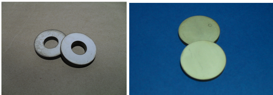
Figura 3-7.: Presentación Física PZTA SMR 3515T55 izquierda, PZTD SMD35T4S311 derecha. Autor.
