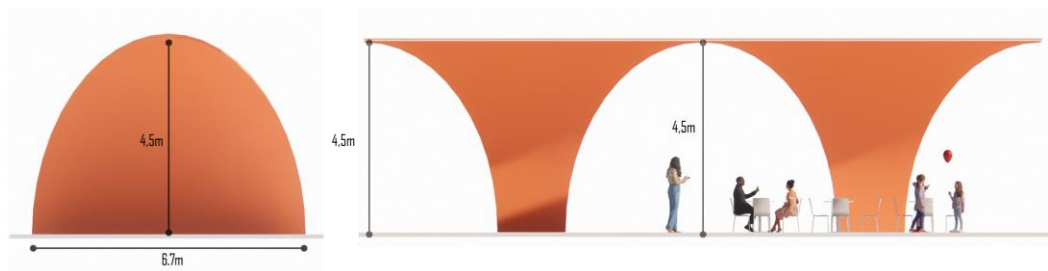
Figura 61. Módulos de cerramiento. (intervención propia)
