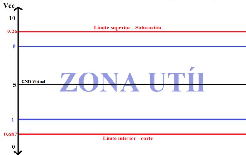
Con el fin de aprovechar el mayor rango de voltaje posible, se calculó la ganancia del amplificador para amplificar la señal de entrada (11.5 mV a máximo torque) en un valor entre 330 a 500 veces mediante la fórmula:
