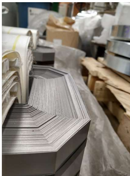
Figura 1-1 Imperfectos en núcleo para transformadores tipo seco (Fuente propia).
