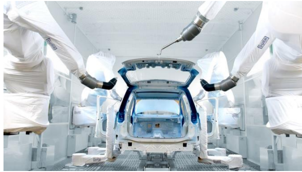
Figura 1 Aplicación de pintura al interior de la carrocería de un automóvil. [1]
