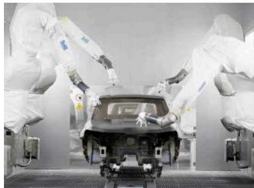
Figura 2. Disposición de brazos robot de aplicación de pintura. [1]
