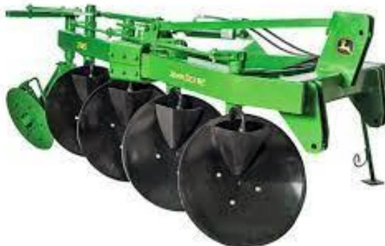
Nota. La figura 1-8 muestra un sistema de arado de triple disco fijado a un monochasis; tomado de (Kobrick, 2019)
