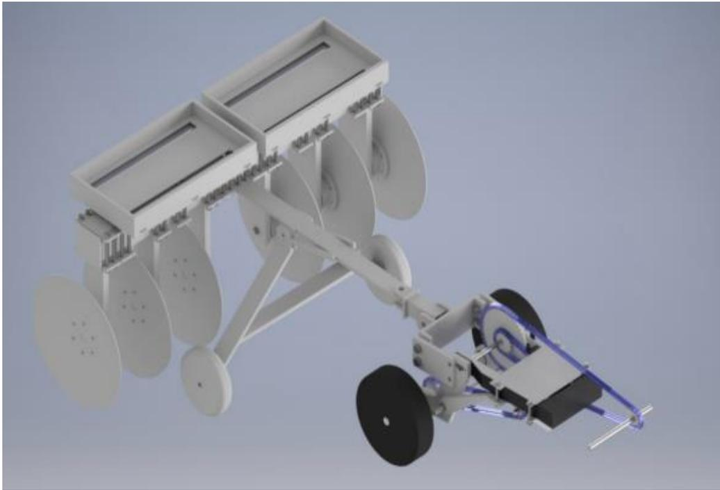
La figura 1-3 muestra un diseño de un sistema de arado por doble disco guiado por una guía móvil tipo barra, tomada de (Escobar, 2020).
