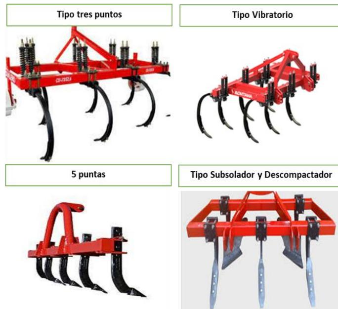
Nota. La figura 1-9 muestra los tipos de arado de sistema cincel existentes a nivel comercial.
