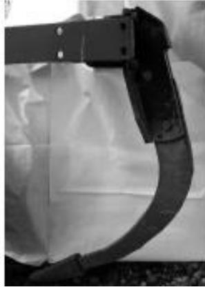
Nota. se muestra en la figura 2-1 un cincel rígido con un ancho de 55 mm, ángulo de ataque de 0,785 rad: tomado de (Camacho, 2007)
