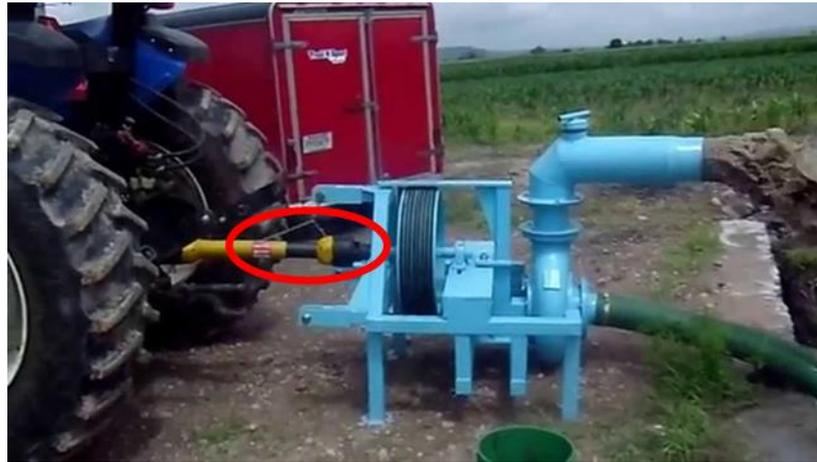
Nota . la figura 3-1 muestra el origen del torque de salida suministrada a una bomba.
