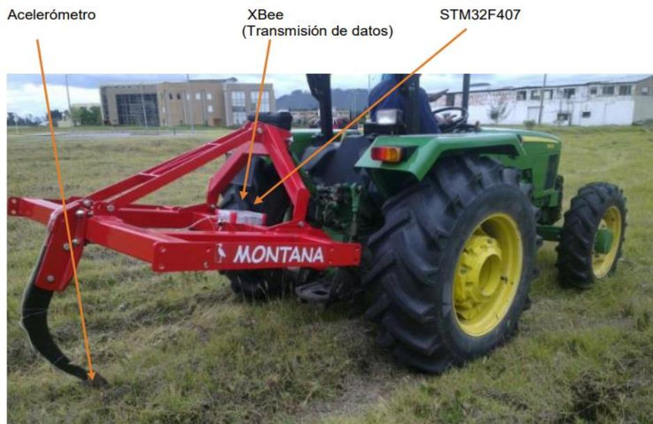
Nota. La figura 1-4 presenta un diseño de un sistema de arado tipo cincel adaptado a un tractor John Deere tipo montaña; tomada de (Morales, 2015).
