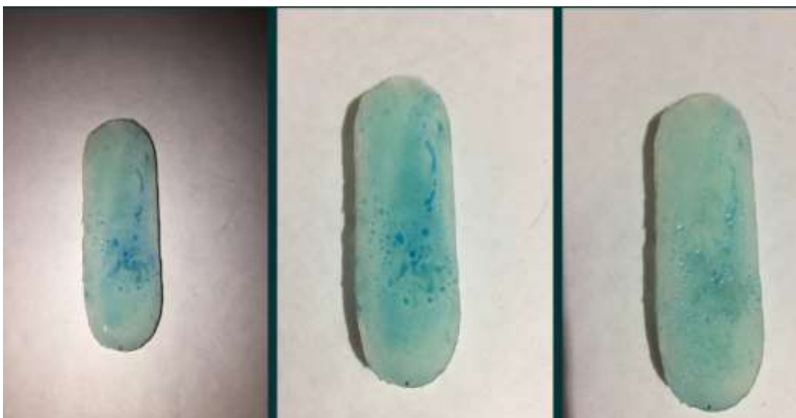
Figura 42. Aplicación del azul de metileno a la muestra desarrollada simulando el contaminante, para aplicar iluminación y determinar el tiempo de degradación total.
