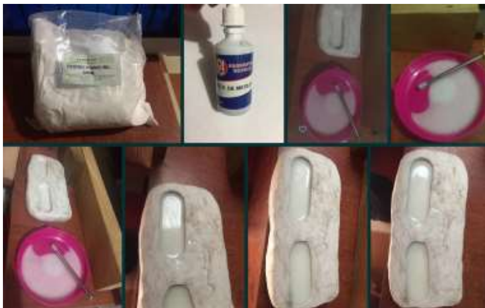
Figura 41. En la imagen podemos observar los materiales necesarios para el protocolo de comprobación. De izquierda a derecha (Dióxido de titanio de anatasa, azul de metileno, recipiente para mezclar resina y catalizador, molde en plastilina industrial).
