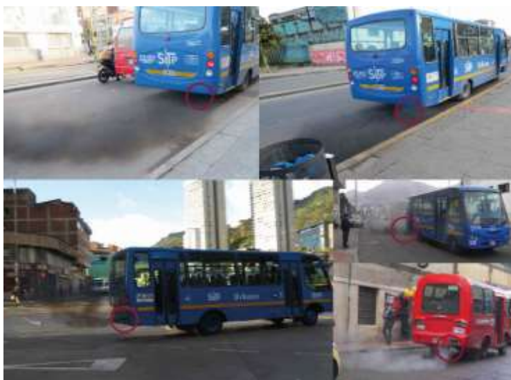
Figura 9. Registro fotográfico. Ubicación del exosto en vehículos del SITP.
