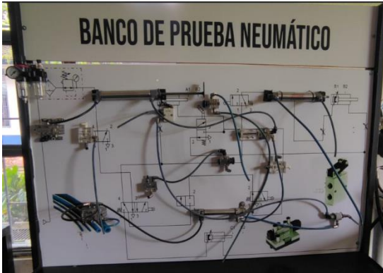
Fig. 4 Tablero neumático del laboratorio de Automatización (foto tomada por el autor)
