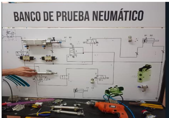
Fig. 11 Tablero neumático del laboratorio de Automatización (foto tomada por el autor)
