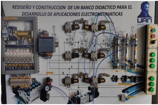
Fig. 3 Tablero electroneumático del laboratorio de Automatización (foto tomada por el autor)
