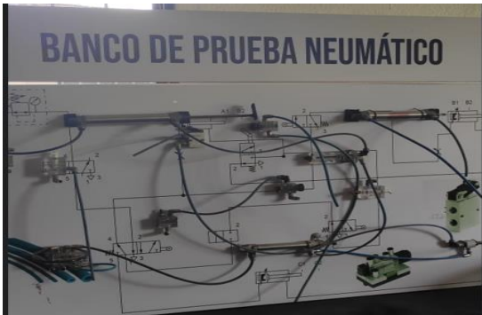
Fig. 5 Tablero neumático del laboratorio de Automatización (foto tomada por el autor)
