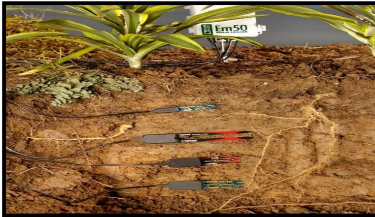
**Fig. 4-6 Sensor de Humedad en Terreno. [15]**
