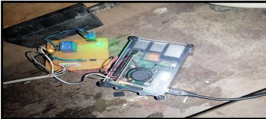
**Fig.5-16.** Conexión de la Raspberry PI Con la tarjeta Rele de 12v.[imagen propia]
