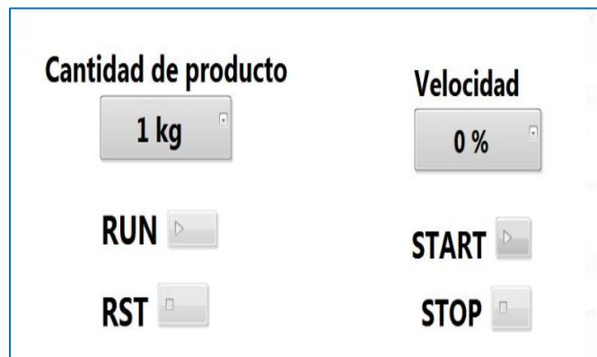
Figura 20. Ventana para selección de producto y velocidad de coolers modo manual
