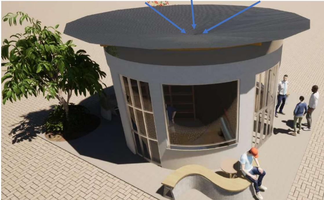
Los módulos tendrán una incorporación tecnológica para la recolección de aguas de lluvias en donde la cubierta está inclinada hacia al centro para garantizar su recolección, además de ello también sobre las cubiertas se instalarán paneles solares donde estos mitigarán el uso de energía.
