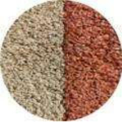
**Goma triturada:** Es un compuesto que se adquiere de la trituración física de elementos como llantas de vehículos, llantas de bicicletas y cauchos de industria, donde su proceso de reciclaje consta en los siguientes pasos:
