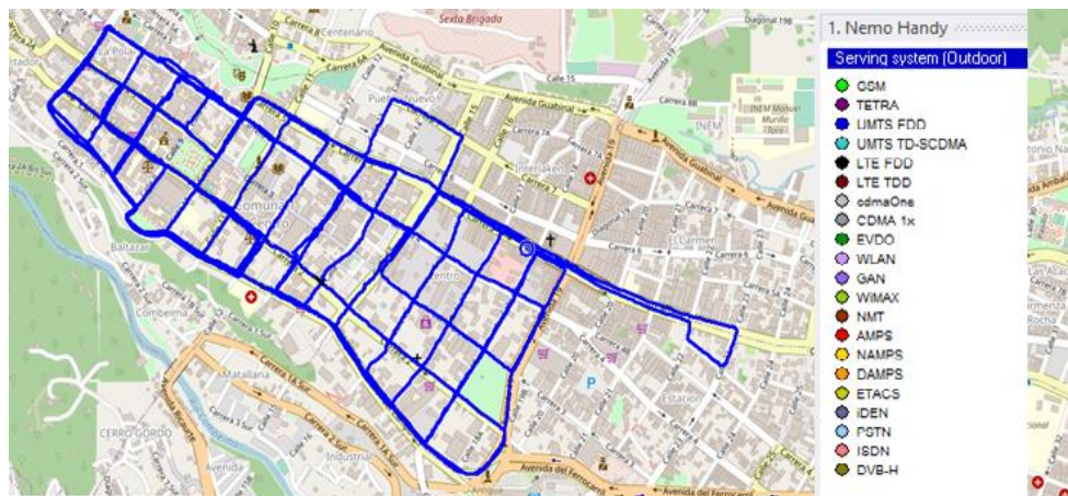
Figura 55: Visualización de el parámetro Serving System del operador Claro, donde se evidencia la tecnología a la que se conectó el dispositivo al realizar la prueba, en este caso de llamadas en UMTS (Simulación de Nemo Outdoor)
