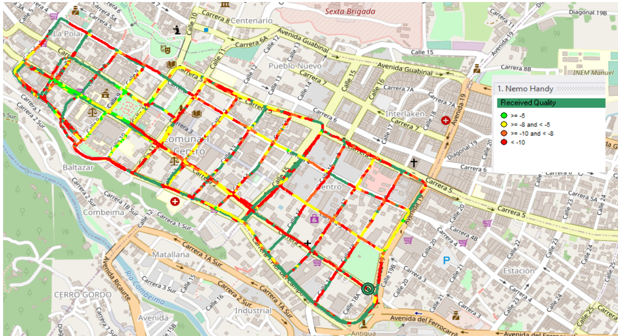
Figura 75: Representa la calidad de referencia de la señal con la que se está transmitiendo. La mayor parte del recorrido presenta niveles menores a -10 dB, por lo que la señal se podrá recibir fácilmente por el usuario (Simulación Nemo Outdoor)
