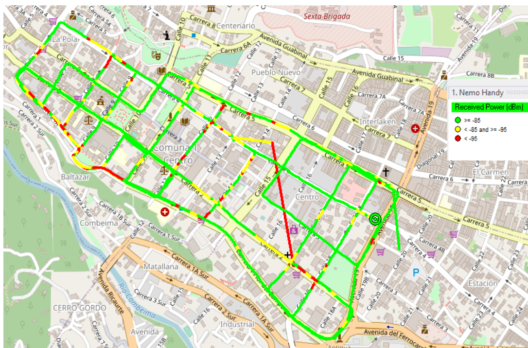
Figura 86: Representa la potencia recibida de señal de referencia en la zona de cobertura, presenta niveles en la mayoría del Drive Test >85 dB (Simulación Nemo Outdoor)
