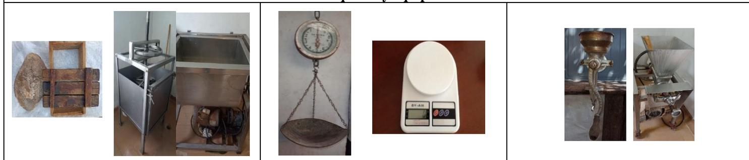
El remplazo de máquinas y equipos artesanales como la prensa, peso y molino permiten la optimización en recursos, tiempo y el resultado final en la fabricación de dicho alimento, también a que el proceso aumente la calidad en el momento de fabricación. Las maquinas y equipos actuales estan fabricados de materiales que propagan gérmenes, sufren de corrosión contaminando el producto, además de no ser los adecuados para la fabricación y manipulación de los alimentos.
