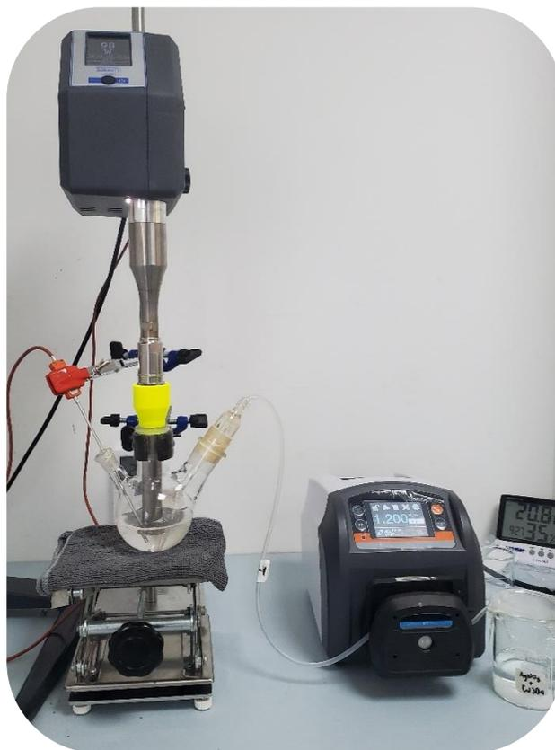
*Figura 1.* Fotografía del montaje para la síntesis de nanopartículas por vía húmeda asistida por irradiación ultrasónica.
