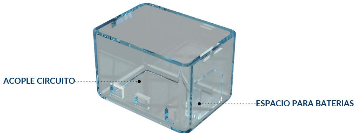
Figura 3-23: Diseño 3D de la carcasa inferior del nodo retransmisor utilizado en la inalámbrica de sensores; elaboración propia.
