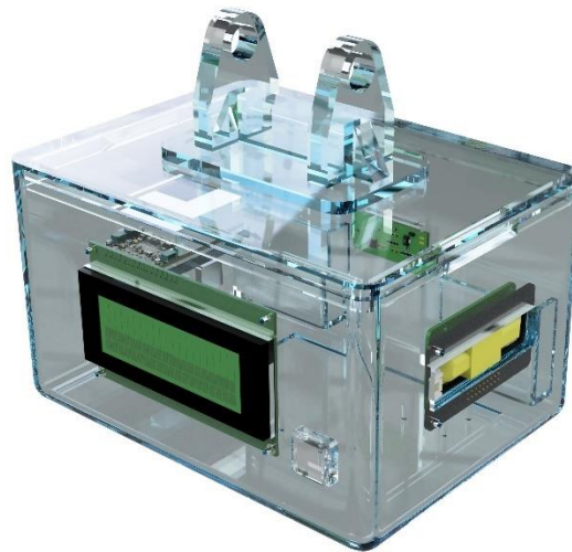
Figura 3-21: Diseño 3D carcasa completa del nodo sensor; elaboración propia.
