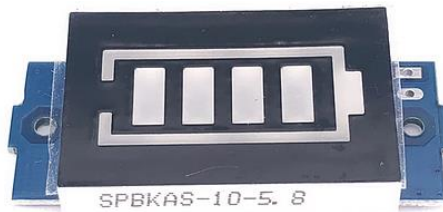
Figura 3-14: Módulo indicador de batería de litio SPBKBS-10-5; tomado de [79].
