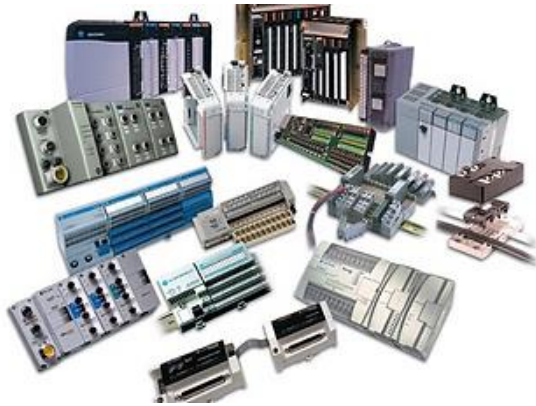
Figura 4-9 Controladores lógicos programables PLC
