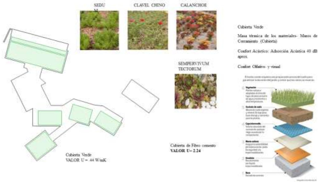
Ilustración 51. Cubierta, Calentamiento Pasivo
