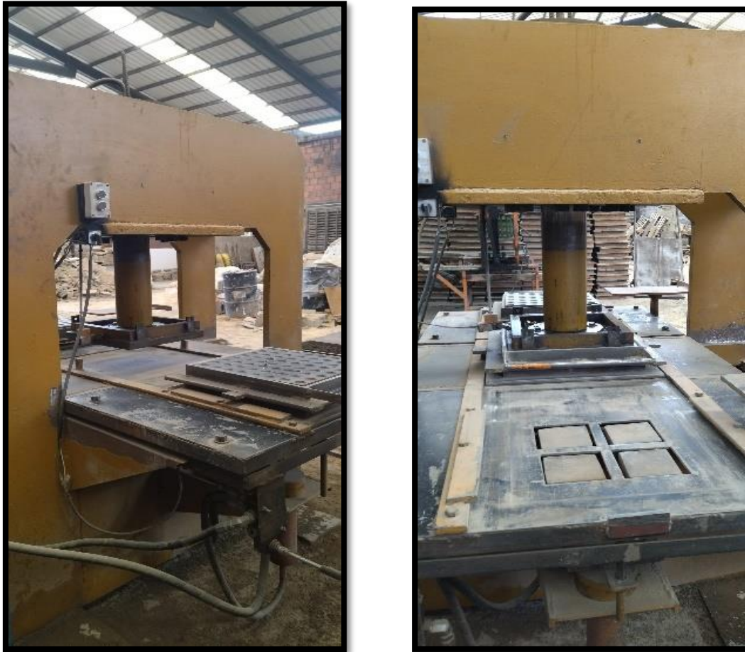
Figura 26 y 27 Máquina de vibrado y compactación de material para losetas prefabricadas.
