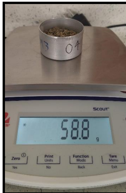
Figura 24 Capsulas con muestras para determinar humedad natural luego de 24h de secado.
