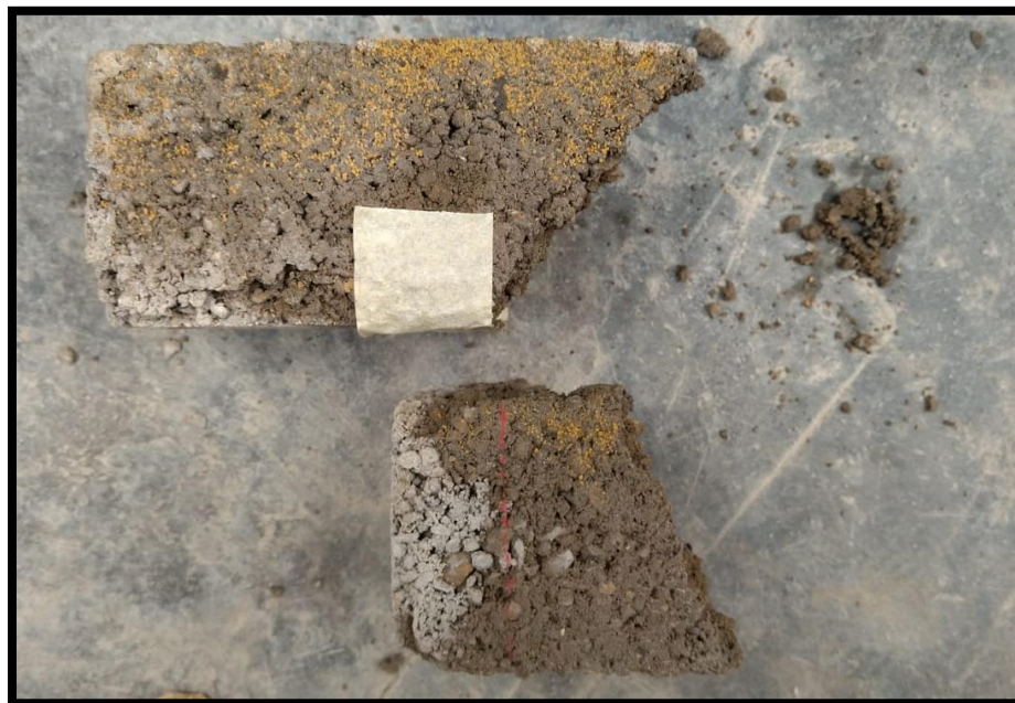
Figura 58 Ruptura de adoquín con adición de 10% de neumático triturado.
