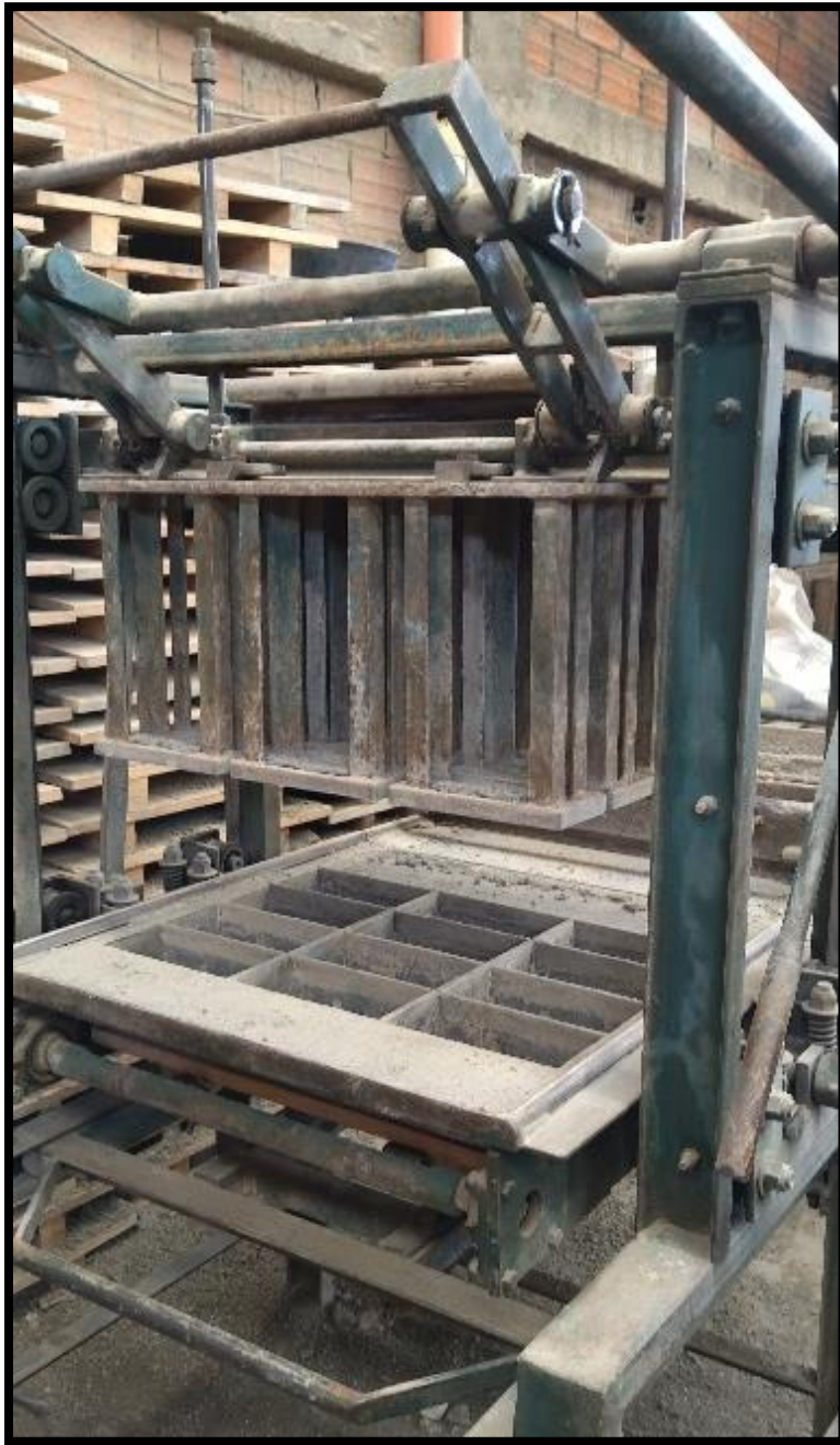
Figura 25 Máquina de vibrado y compactación de material para adoquines.
