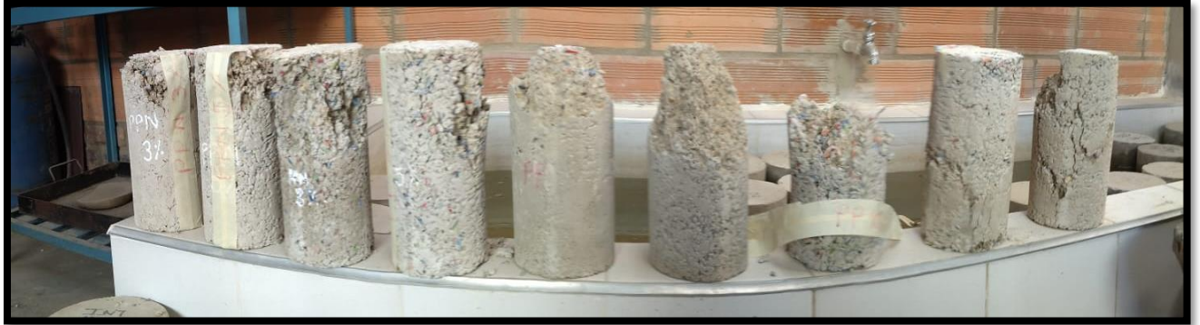
Figura 50 Cilindros fallados a compresión.
