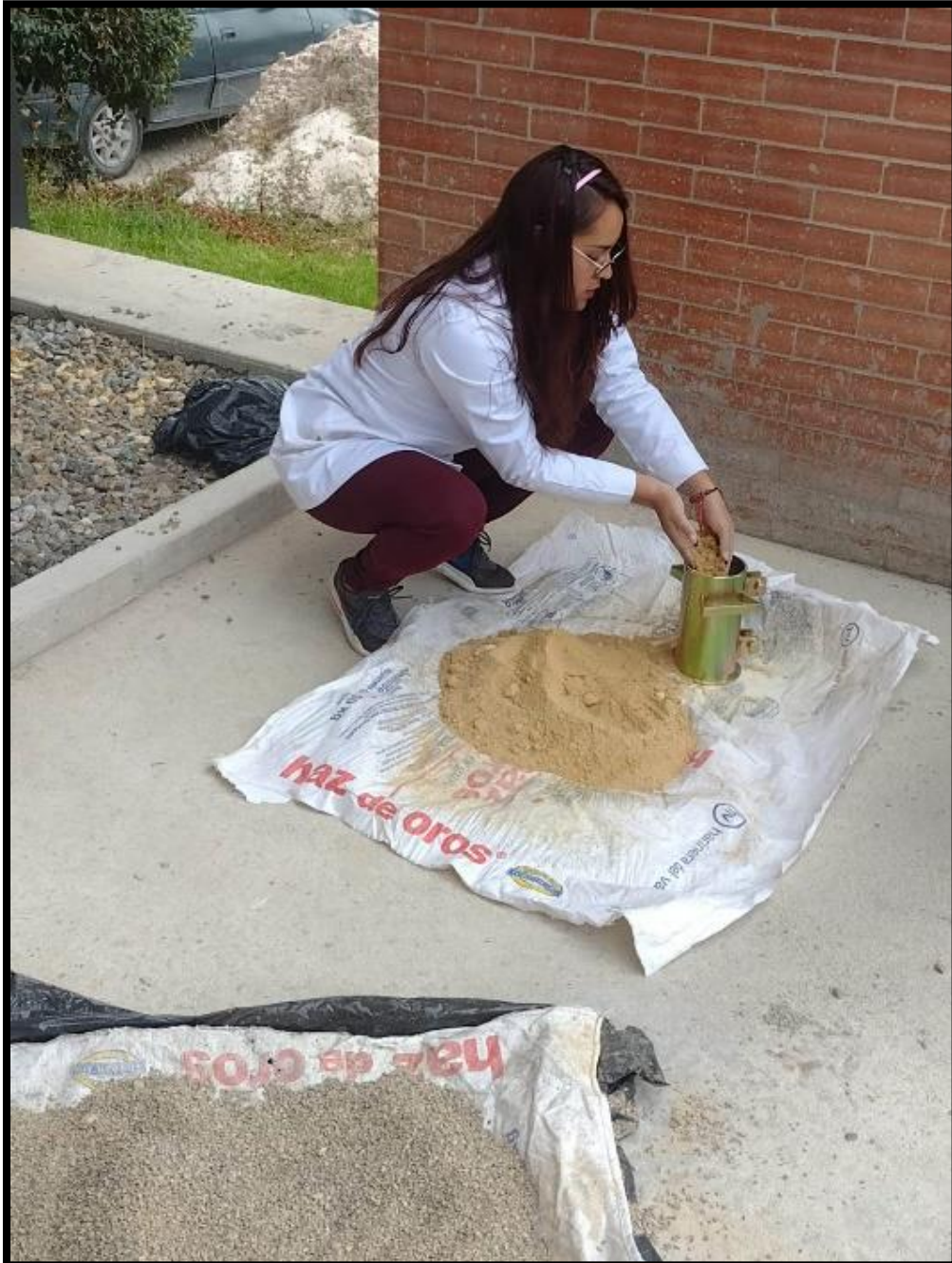
Figura 18 Laboratorio para determinar masa unitaria suelta (MUS).
