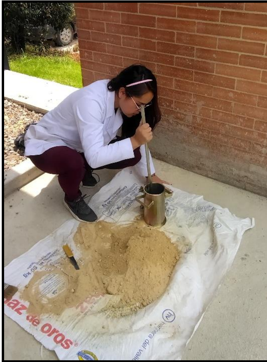
Figura 20 Laboratorio para determinar masa unitaria apisonada (MUA).
