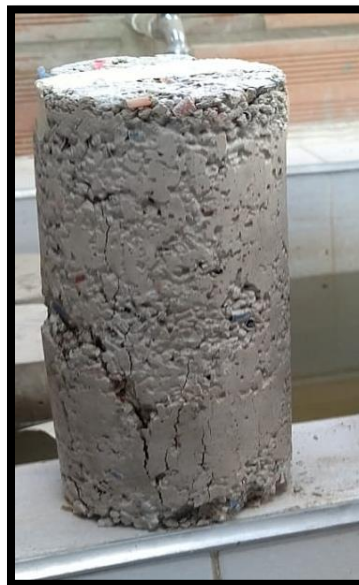
Figura 53 Falla a compresión de cilindro a base de solo neumático
