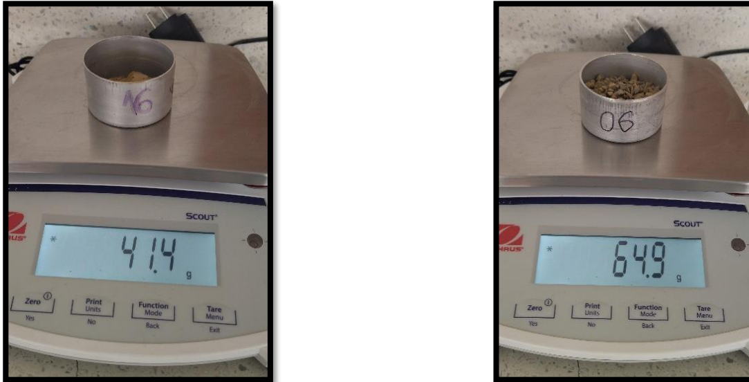
Figura 22 y 23 Capsulas con muestras para determinar humedad natural.
