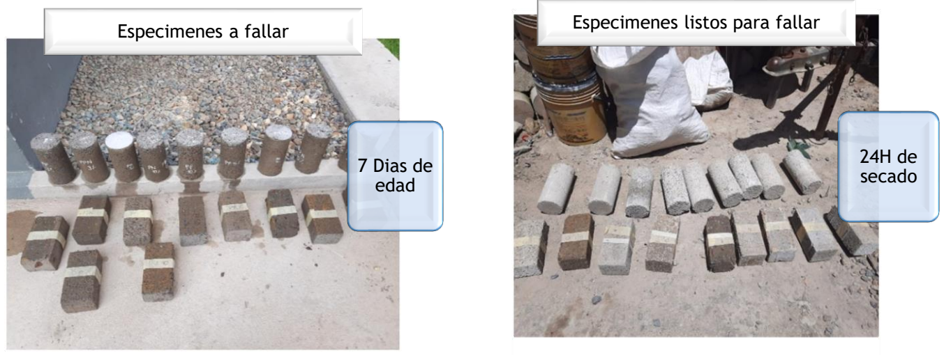
Figura 49 Especímenes listos para fallar luego de 7 días de edad
