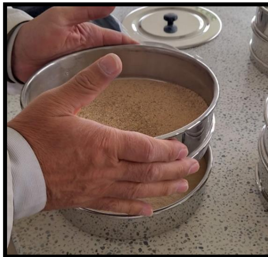
Figura 13 Agregado fino pasado por tamiz 40 para límites líquido y plástico.
