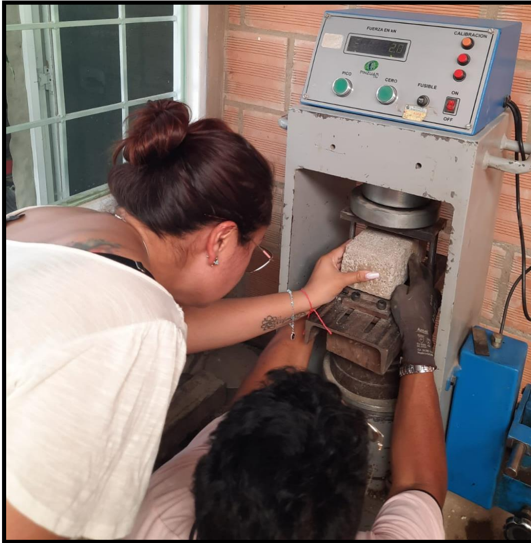
Figura 54 Falla a tres puntos para adoquines vehiculares
