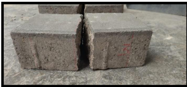
Figura 67 y 68 Ruptura de adoquín con 28 días de edad encontrado en el comercio actual.
