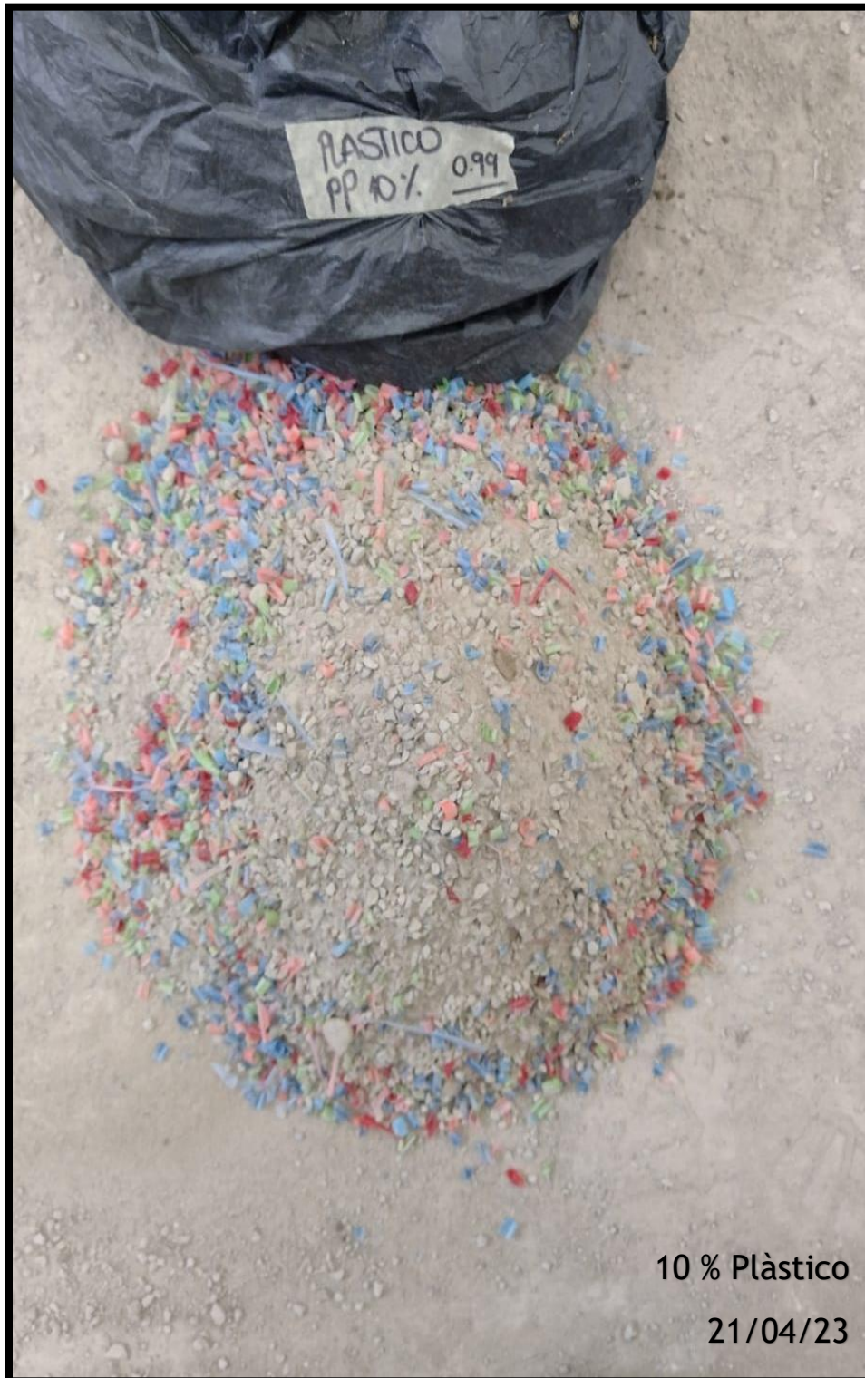
Figura 32 Adición de 10% de plástico según dosificaciones establecida por metodología ACI.
