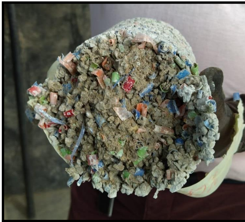
Figura 51 Cilindro fallado a compresión con solo adiciones de plástico
