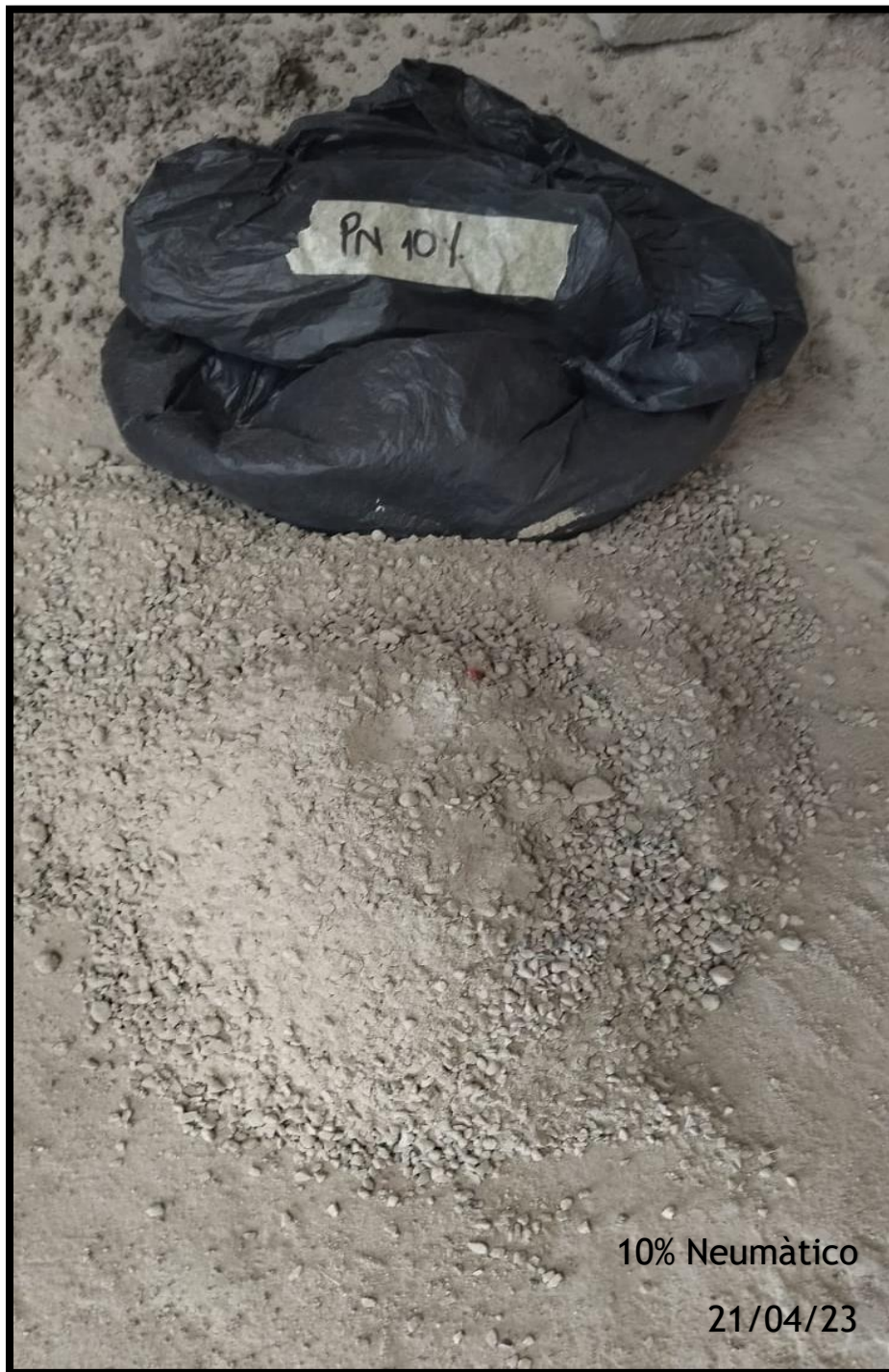
Figura 30 Adición de 10% neumático según dosificaciones establecida por metodología ACI.
