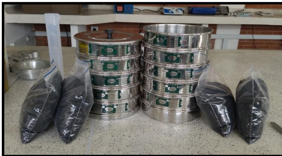
Figura 11 Tamices junto al caucho Malla 30 (M 30 - 0.6mm), malla 25 (M 25 - 1.0 mm), malla 10 (M 10 - 2.0 mm) y malla 5 (M 5 - 4.0 mm)
