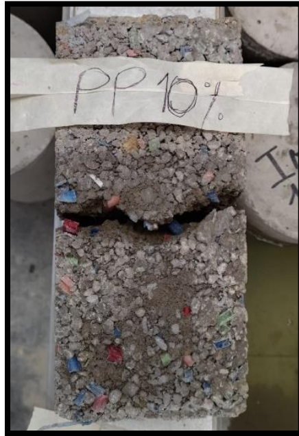
Figura 57 Ruptura de adoquín con adición de 10% de polietileno de alta densidad.
