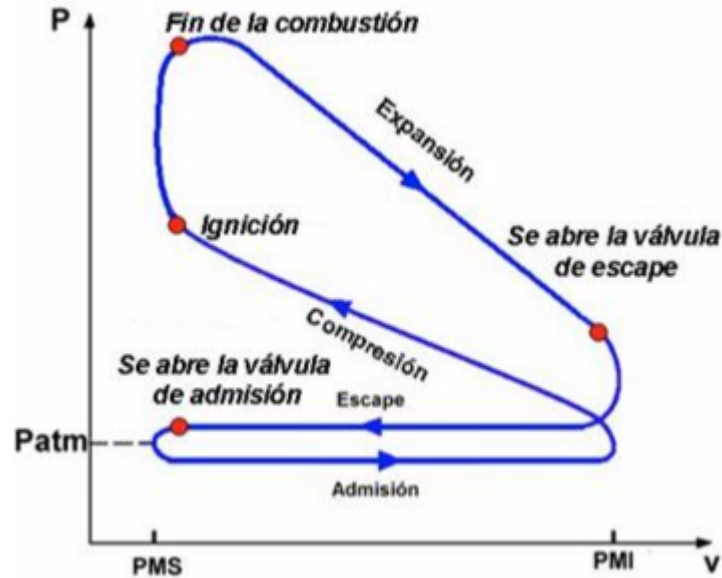
Figura 6.1.3: Diagrama pV del motor real encendido por chispa de cuatro tiempos
