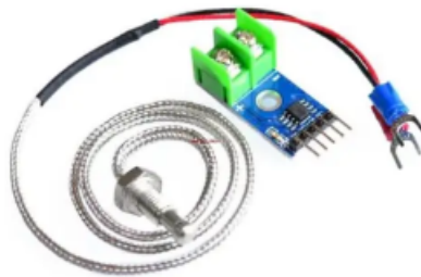
Figura 7.3.10: Sensor y módulo MAX6675
