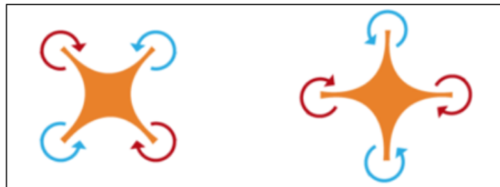
Figura 3.1: Sentidos de los rotores cuadricóptero
