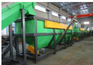
Tanque Lavado Flotante No1
