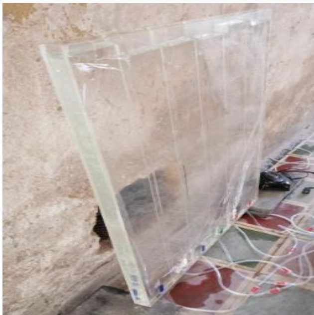
Figura 600: Pruebas de fuga en la pared de acrílico.
