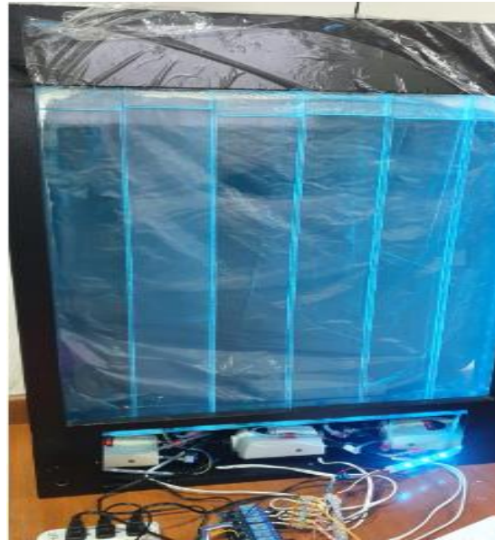
Figura 633: Sistema de iluminación LED.
