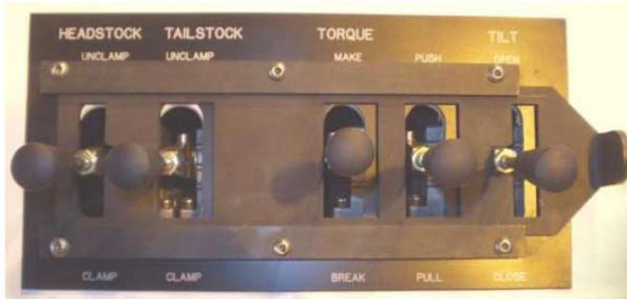
Ilustración 39: Palancas de accionamiento banco de válvulas principal, Fuente: Autor
