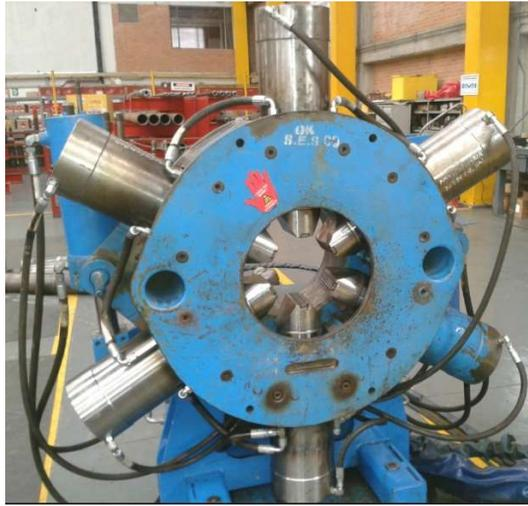
Ilustración 4: Cilindros de agarre cabezal rotatorio móvil. Fuente: autor
