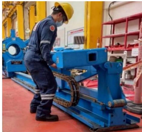
*Ilustración 11: Levantamiento manual de estructura articulable, Fuente: Autor*
