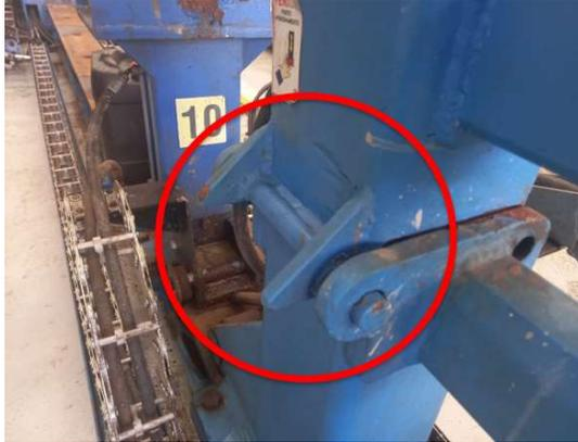
Ilustración 31: Anclaje de la estructura articulable del Push & Pull, Fuente: Autor
