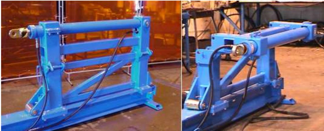
*Ilustración 7: Sistema Push & Pull posición operativa y reposo (izquierda a derecha). Fuente: autor*
