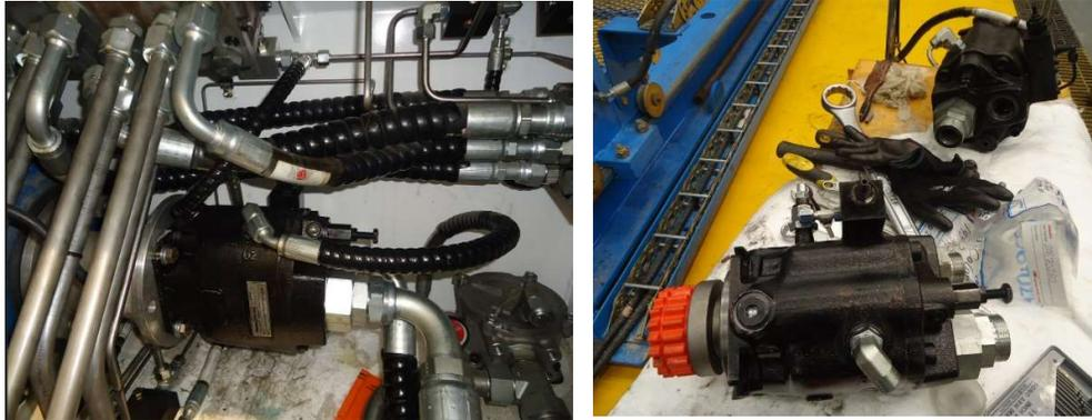
*Ilustración 22: Bomba hidráulica Torquemaster, Fuente: Autor*
