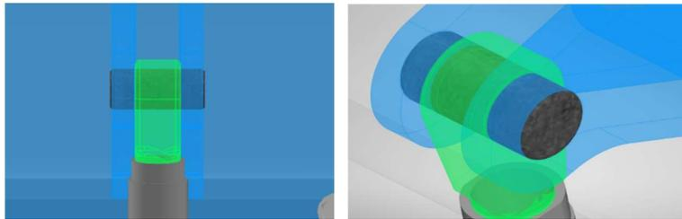
Ilustración 70: . bulón de unión soporte articulado superior y cabeza vástago, Fuente: Autor
