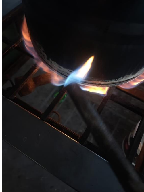
Figura 16 Generación de gas de LDPE. Fuente: Autores 2022
