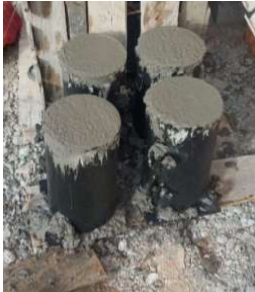
Figura 17. Muestra de ensayos de cilindro de concreto.
