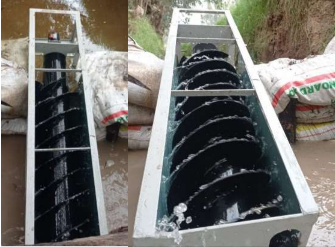
Hidrotornillo puesto en funcionamiento.
