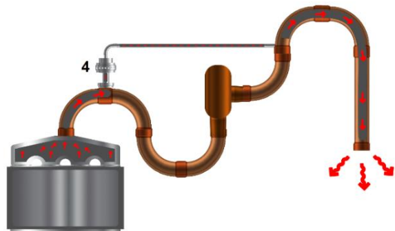
Fig. 15. Diagrama del flujo de gases de escape, con válvula de descarga. Fuente Interna
