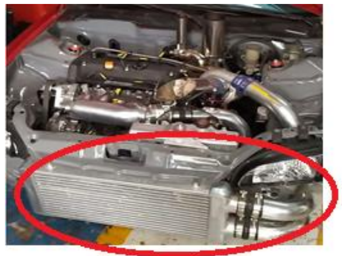
Fig. 24. Ensamble turbo motor Honda K20 en Honda Civic Eg. Intercooler frontal. Fuente interna. Nippon Motorsport.
