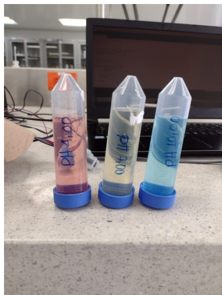
Figura 2-31: Soluciones buffer utilizadas en el laboratorio con valores de pH de 4, 7 y 10 (Fuente: Los autores).
