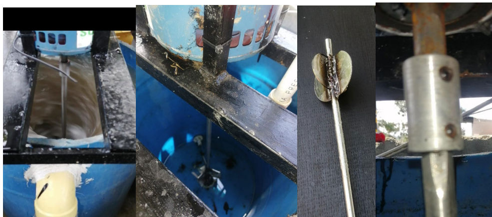
Figura 2-19: Agitación principal en el tanque de flotación. (Fuente: los autores).
