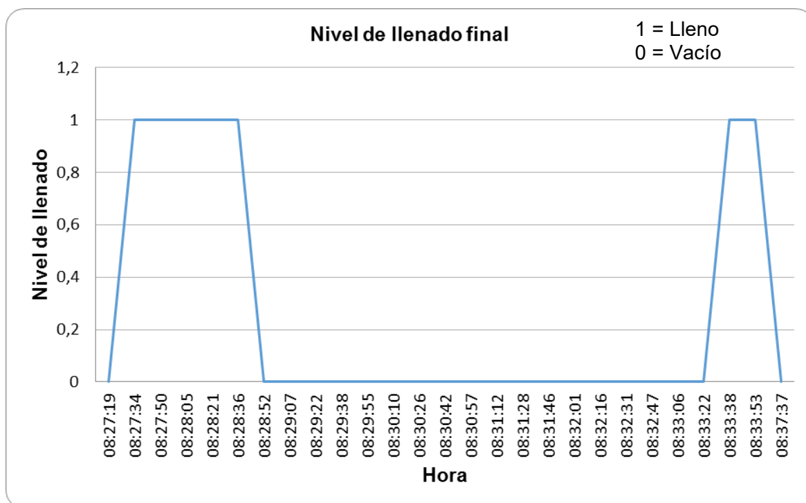
Gráfico 3-5: Mediciones extraídas de Thingspeak del nivel de llenado ubicado en el tanque de almacenamiento final (Fuente: Los autores).
