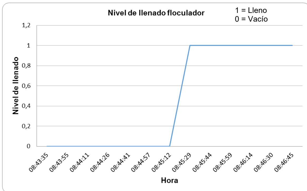
Gráfico 3-4: Mediciones extraídas de Thingspeak del nivel de llenado ubicado en el tanque floculador (Fuente: Los autores).
