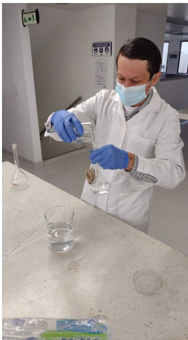
Figura 4-4: Medición del pH en muestras para el ajuste del sensor de pH utilizado en el proyecto (Fuente: Los autores).
