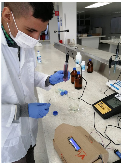
Figura 4-4: Medición del pH en muestras para el ajuste del sensor de pH utilizado en el proyecto (Fuente: Los autores).
