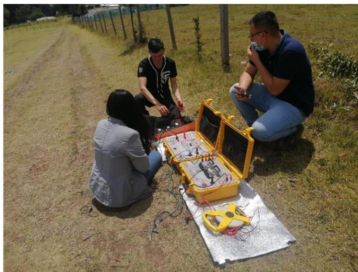
Figura 26: Instalación método Wenner
