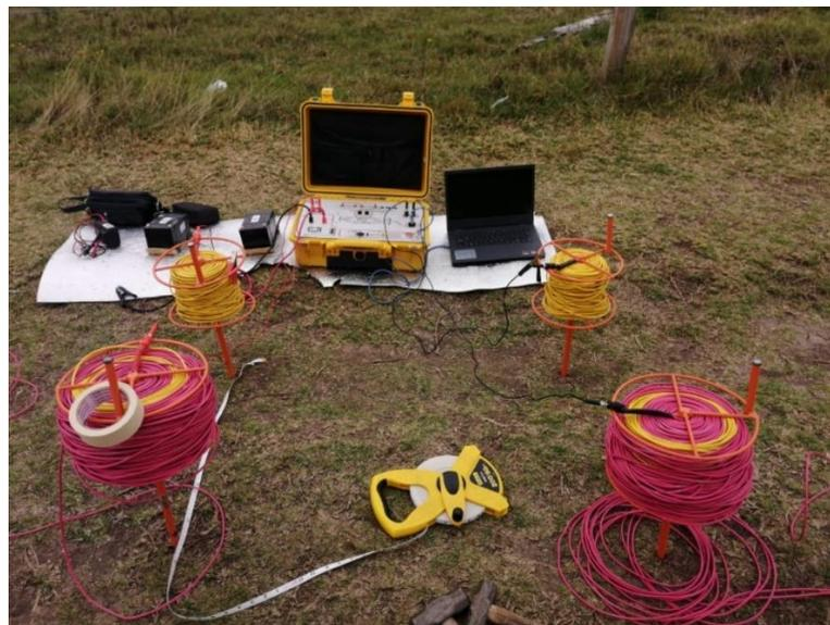
Figura 31: Configuración Schlumberger
