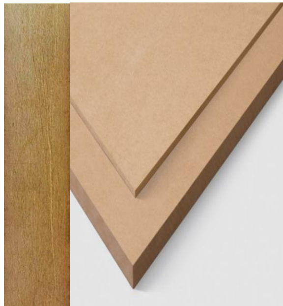
Figura 54: Corte Transversal (izquierda) y superficie (derecha) MDF [22]
