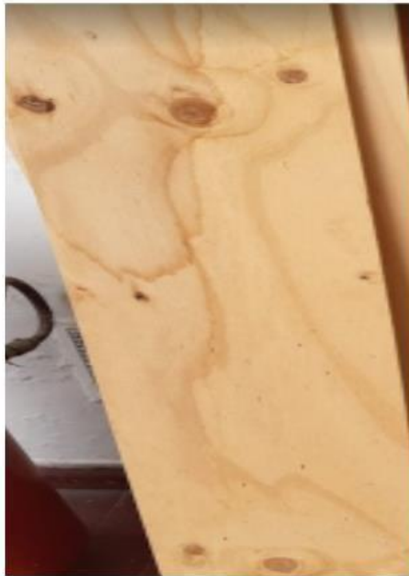
Figura 28: Superficie de Tríplex de pino de 6,5 mm de espesor.
