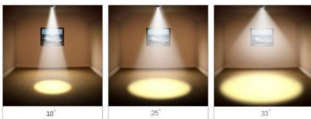
Figura 6: Apertura de haz a 10°, 25 y 33°. [6]
