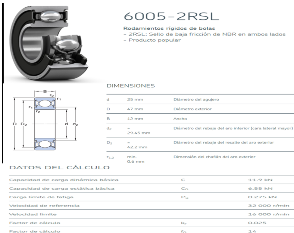
Figura 3-2. Características del rodamiento 6005-2RSL
