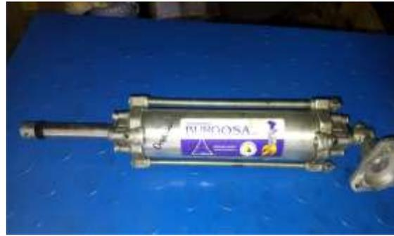
Fig. 4. Cilindro neumático. Fuente: Propia.
