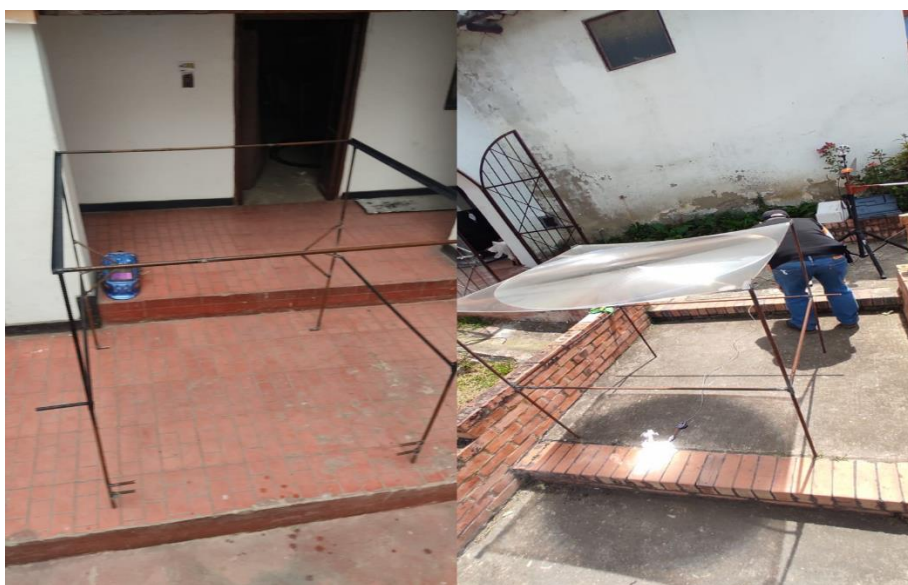
Figura 18. Estructura de soporte y lente Fresnel – Propia del autor.
