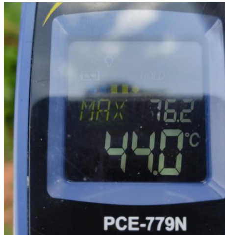
Figura 31. Termómetro infrarrojo PCE-779N, la medición máxima corresponde a los medios focos, el ultimo registro de medición corresponde a la línea focal formada por la canal parabólica; Propia del autor.
