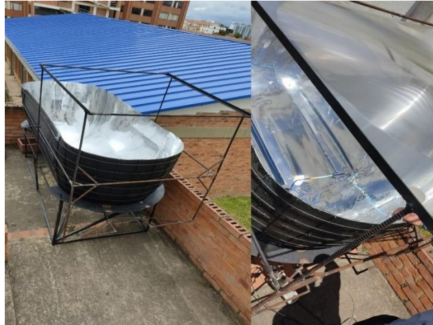
Figura 32. Estructura para montaje de lente Fresnel y lente en el montaje; Propia del autor.
