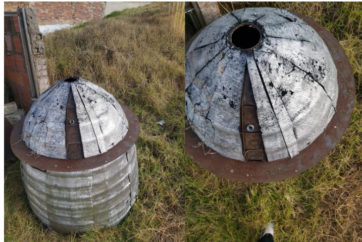
Figura 17. Estado del concentrador solar cilindro parabólico combinado con reflector solar de espejo plano. Propia del autor.
