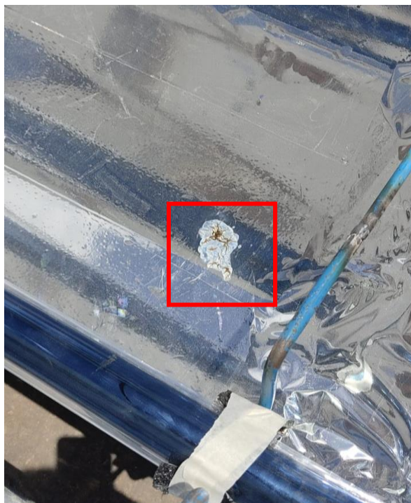
Figura 33. Daños del Fresnel al material reflectivo del Concentrador solar híbrido; Propia del autor
