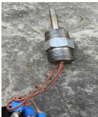
Figura 30. TC-100 fundido debido a una elevada temperatura para la cual no está diseñada; Propia del autor.
