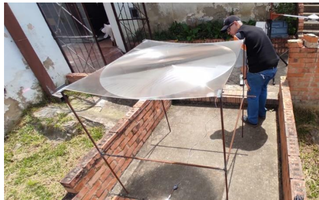
Figura 29. Toma de datos del lente Fresnel. Propia del autor
