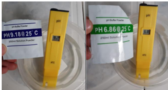
Figura 2-26: Calibración dispositivo pH-009(I)A. Fuente: Autor
